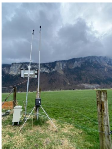
Appareil de mesure du bruit de l'association IGF aux abords de la piste de l'aérodrome de Meiringen. [RTS - Stéphane Deleury]
